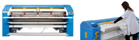
В отличие от гладильных катков, которые предназначены только для глажения белья, гладильно-сушильные каландры Lavarini предназначены для глажения и сушки плоского белья. На выходе белье имеет 20% влажности. Управление при помощи микропроцессора IM7 — 30 программ для глажения. Контроль температуры и скорости глажения. Функция подачи на возврат белья.
